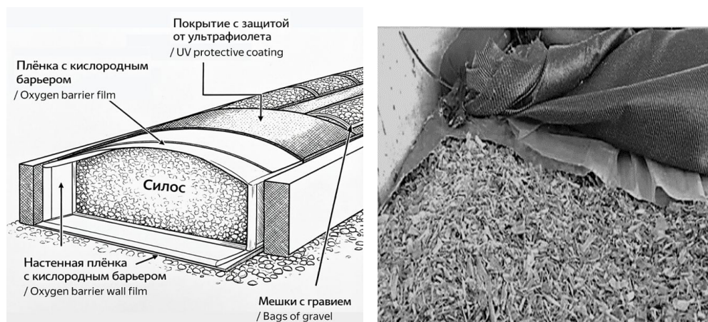
Рисунок 2. Схема многослойной герметизации силоса с использованием системы Silostop в производственных условиях (Ламанов А., 2016)
